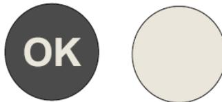
Si «OK» n'apparaît pas, la température de la zone est trop élevée. Réglez le thermostat sur une position supérieure. Attendez au moins 12 heures avant de réajuster le thermostat. Après le chargement des denrées fraîches dans l'appareil ou après les ouvertures répétées (ou ouverture prolongée) de la porte, il est normal que l'inscription «OK» n'apparaît pas dans l'indicateur de température.
