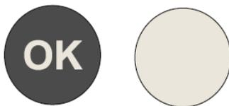
Si no aparece 'OK', la temperatura en esa parte es demasiado alta. Ajuste el termostato a una posición más alta. Espere al menos 12 horas antes de volver a ajustar el termostato. Después de colocar alimentos frescos dentro del aparato o después de la apertura repetida (o prolongada) de la puerta, es normal que la indicación 'OK' no se muestre en el indicador de temperatura.
