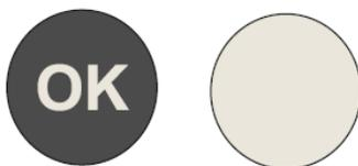
Se "OK" non viene visualizzato, significa che la temperatura in quella parte è troppo elevata. Impostare il termostato su una posizione più alta. Attendere almeno 12 ore prima di regolare nuovamente il termostato. Dopo aver inserito alimenti freschi all'interno dell'elettrodomestico o dopo ripetute (o prolungate) aperture della porta, è normale che l'indicazione "OK" non venga visualizzata sull'indicatore.
