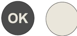
Εάν δεν εμφανίζεται το 'OK', η θερμοκρασία σε αυτό το τμήμα είναι πολύ υψηλή. Ρυθμίστε τον θερμοστάτη σε υψηλότερη θέση. Περιμένετε τουλάχιστον 12 ώρες πριν ρυθμίσετε ξανά τον θερμοστάτη. Αφού τοποθετήσετε φρέσκα τρόφιμα μέσα στη συσκευή ή μετά από επαναλαμβανόμενο (ή παρατεταμένο) άνοιγμα της πόρτας, είναι φυσιολογικό να μην εμφανίζεται η ένδειξη 'OK' στην ένδειξη θερμοκρασίας.
