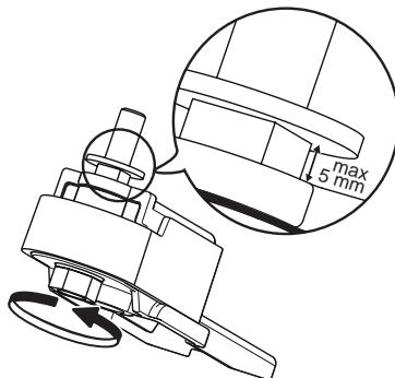
Jeżeli drzwi chłodziarki znajdują się poniżej poziomu chłodziarki, należy podnieść drzwi zamrażarki obracając śrubę regulującą w kierunku przeciwnym do ruchu wskazówek zegara za pomocą klucza w rozmiarze M10.
