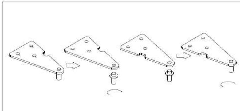
8 Remontez la porte et la charnière supérieure sur le côté gauche. Assurez-vous que la porte soit bien alignée, de sorte que les joints soient comprimés sur tous les côtés avant de fixer la charnière supérieure. Si nécessaire, utilisez une clé pour serrer la charnière.
