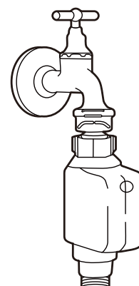
tuyau d'arrivée d'eau de sécurité
