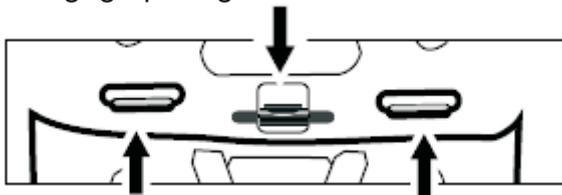
Vérifiez les roulements situés sous le crochet avant chaque lavage, ils doivent rouler librement.
