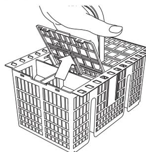
**Les couteaux et autres ustensiles avec des bords tranchants doivent être placés dans le panier à couvert avec la pointe vers le bas, ou placés à l'horizontale dans le compartiment rabattable sur le panier supérieur.**
