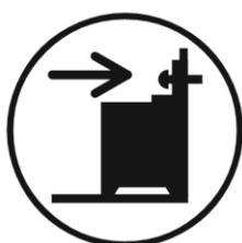
**MISE EN GARDE: Le dispositif de stabilisation doit être mis en place pour éviter le basculement de l'appareil.**
