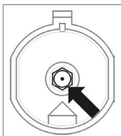
*Changement de l'injecteur du brûleur de la plaque de cuisson – dévisser l'injecteur à l'aide d'une clé d'un diamètre 7 et le remplacer par un injecteur adapté à la famille de gaz (voir tableau de correspondance)*
