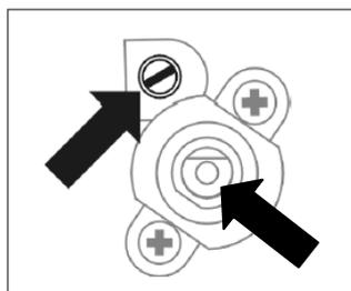
*Emplacement de la vis de réglage de la flamme dans le robinet en fonction des types de robinets existants (valve de réglage)*
