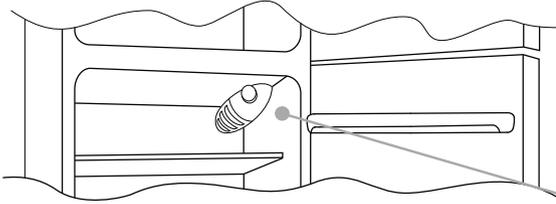
Le thermostat commandant l'appareil se trouve en haut à droite à l'intérieur du réfrigérateur. Pour vérifier que l'appareil fonctionne, assurez-vous que le bouton du thermostat ne se trouve pas en position "0".
