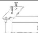
Retirez le cache du côté gauche et insérez-le dans le trou du côté droit de la porte.
