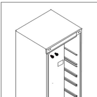
4. Déposez délicatement l'arrière de l'armoire sur une surface matelassée. Commencez par retirer les deux pieds de réglage. Dévissez ensuite la charnière de la porte ainsi que la base du pied du côté gauche
