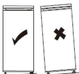
Si l'appareil n'est pas à niveau, les portes ne seront pas correctement alignés et l'étanchéité des compartiments peut ne pas être assurée.
