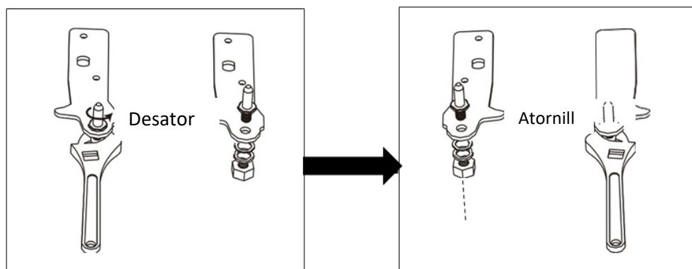
6. Instale la bisagra en el lado izquierdo y la base de la pata en el derecho. A continuación, atornille las dos patas de ajuste con sus piezas originales.
