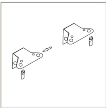
8. Levante el aparato y coloque la puerta sobre la bisagra inferior. Compruebe que la varilla de la bisagra inferior está insertada en el agujero de la puerta. A continuación, instale la bisagra superior en la puerta. Antes de apretar la bisagra superior, pruebe a abrir la puerta para comprobar que el aparato cierra bien. Por último, atornille la tapeta de la bisagra en la bisagra.
