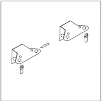
8. Σηκώστε τη συσκευή και τοποθετήστε την πόρτα στον κάτω μεντεσέ. Ελέγξτε ότι η ράβδος του κάτω μεντεσέ έχει εισαχθεί στην οπή της πόρτας. Στη συνέχεια, τοποθετήστε τον επάνω μεντεσέ στην πόρτα. Πριν σφίξετε τον επάνω μεντεσέ, προσπαθήστε να ανοίξετε την πόρτα για να ελέγξετε ότι η συσκευή κλείνει καλά. Τέλος, βιδώστε το κάλυμμα μεντεσέδων στον μεντεσέ
