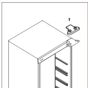
2. Abra la puerta y afloje la bisagra superior. A continuación, levante la puerta para sacarla del aparato y colóquela sobre la espuma para evitar que se raye.
