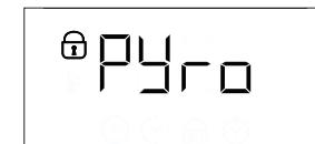
Une fois le cycle terminé, la porte reste verrouillée jusqu'à ce que la température à l'intérieur du four atteigne un niveau sécuritaire. Aérez la pièce pendant et après avoir utilisé le cycle Pyro.
