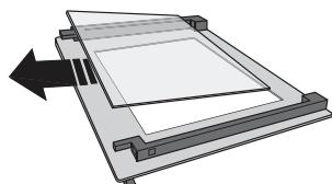
3. Réinstaller le panneau intermédiaire (marqué d'un "1R") Avant de remonter le panneau intérieur : Pour placer correctement les parois de verre, assurez-vous que la marque « R » se trouve dans le coin gauche. En premier, insérez la longue partie de la vitre marquée d'un « R » dans les appuis des guides, abaissez-la ensuite en place. Répétez cette procédure pour les deux parois de verre.
