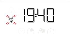
Let op: Tijdens de bereiding kan de functie gewijzigd worden door de *keuzeknop* te draaien of de temperatuur te regelen met de *thermostaatknop*. De functie zal niet starten als de *thermostaatknop* op **0 / AUTO** staat. U kunt het einde van de bereiding (alleen wanneer een bereidingstijd ingesteld wordt) en een kookwrekker selecteren.
