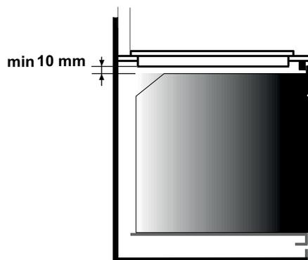
Un joint d'étanchéité à l'eau est fourni avec la table de cuisson. Posez le joint d'étanchéité bien soigneusement tout autour de la partie inférieure de la table de cuisson, comme illustré, afin d'empêcher toute fuite dans le meuble d'encastrement.
