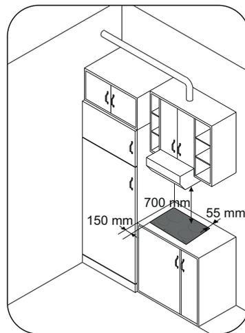
Si la partie inférieure de la table de cuisson confine avec un espace accessible pour des opérations de maintenance ou de nettoyage, un panneau de séparation doit être installé 20 mm au-dessous de la table de cuisson
