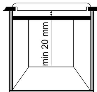
L'installation d'un four au-dessous de la table de cuisson ne requiert pas de panneau de séparation, mais la distance minimum entre la partie inférieure de la table de cuisson et le four doit être de 10 mm. Seul un four avec système de refroidissement peut être installé sous la table de cuisson, selon ses propres consignes d'installation.
