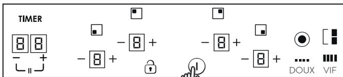
**Pour allumer** un foyer de cuisson, touchez la zone de commande correspondante pendant 400 ms. Un long bip retentit et le chiffre « 0 » s'affiche pour cette zone, indiquant le niveau de chauffe.
