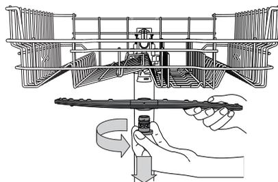
Pour enlever le bras d'aspersion supérieur, tournez l'anneau de verrouillage en plastique dans le sens antihoraire. Le bras d'aspersion supérieur doit être remplacé de façon que le côté avec le plus grand nombre de trous est placé vers le haut.
