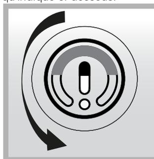
Si l'un ou les deux liquides sont dissous, cela indique que la température dans le compartiment congélateur a augmenté. Même la fusion partielle de l'un des deux liquides peut révéler une augmentation anormale de la température interne. Si le liquide A1 est dissous, alors les aliments doivent se consommer dans un délai d'une semaine. Si le liquide A2 dissous, alors les aliments doivent être jetés.
