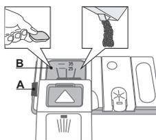
**Pour ouvrir le distributeur de détergent, utilisez le dispositif d'ouverture A. Insérez le détergent dans le distributeur sec B seulement.**
