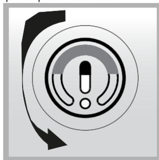
Si l'un ou les deux liquides sont dissous, cela indique que la température dans le compartiment congélateur a augmenté. Même la fusion partielle de l'un des deux liquides peut révéler une augmentation anormale de la température interne. Si le liquide A1 est dissous, alors les aliments doivent se consommer dans un délai d'une semaine. Si le liquide A2 dissous, alors les aliments doivent être jetés.
