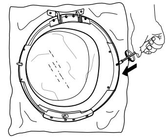
**19.** Fixez les deux vis au-dessus et sous le verrou de porte, sur le côté droit de l'ouverture de porte.
