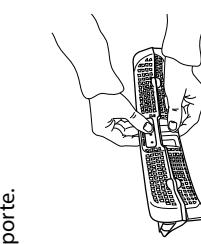
5. Fermez le filtre et réinsérez-le dans la bonne direction de sorte qu'il intègre totalement le compartiment de filtre.
