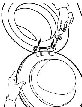
**18.** Insérez le verrou de porte sur le côté droit de l'ouverture de porte. Appuyez dessus totalement à l'intérieur du trou et déplacez-le légèrement vers le bas, jusqu'à ce que le petit bouton du verrou de porte s'enclenche.
