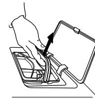
5. Essorez minutieusement la mousse du filtre. Ne l'insérez pas dans le filtre inférieur trop humide.
