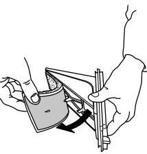
6. Fixez la mousse de filtre sur le filtre inférieur.
