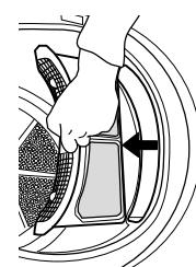
3. Enlevez avec précaution toutes les peluches du filtre à la main. Si nécessaire, le filtre peut être nettoyé également sous l'eau courante, en utilisant un chiffon doux.
