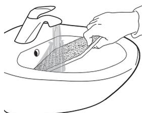
**5.** Essorez minutieusement la mousse du filtre. Ne l'insérez pas dans le filtre inférieur trop humide.
