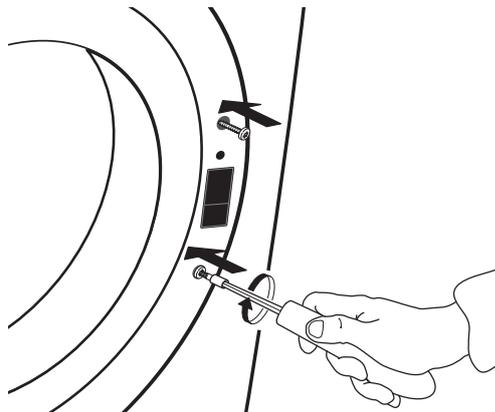
**20.** Fixez la porte sur le côté gauche de l'ouverture de porte en tournant les deux vis.
