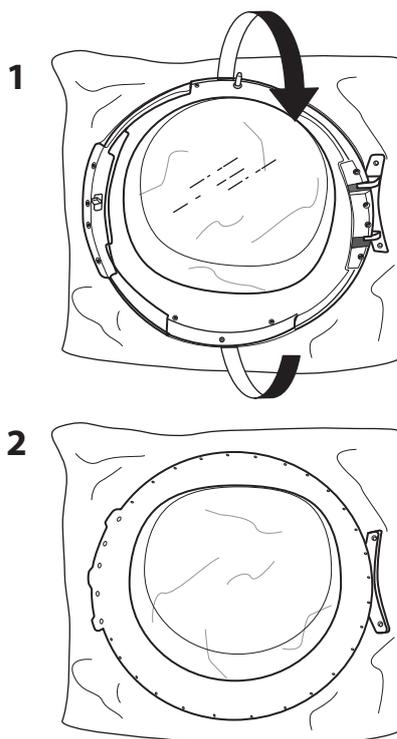
**16.** Réinstallez le châssis de porte.
